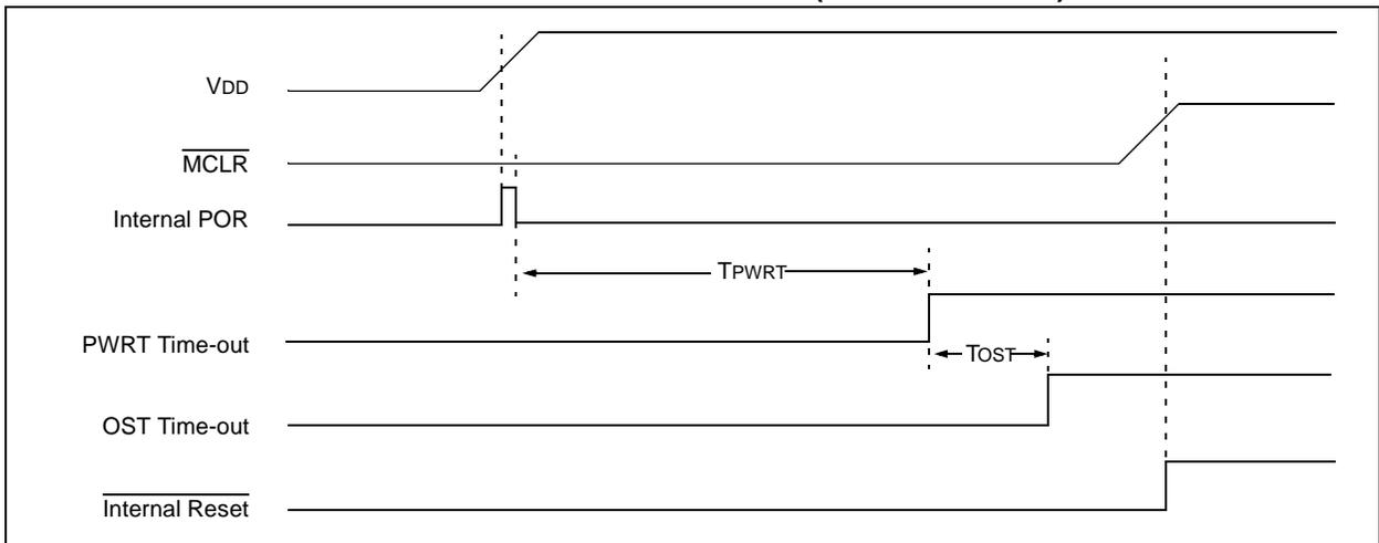
**FIGURE 15-6: TIME-OUT SEQUENCE ON POWER-UP ( $\overline{\text{MCLR}}$  WITH  $V_{DD}$ )**
